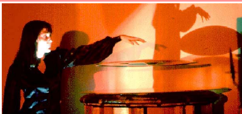
Figure 4 : Lévitation par courants induits.
