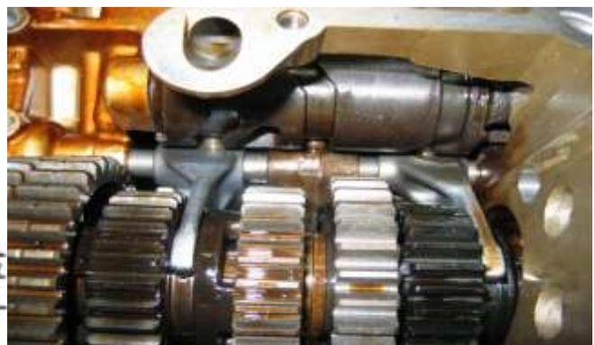
Figure 4 : la rotation du barillet provoque la translation des fourchettes
